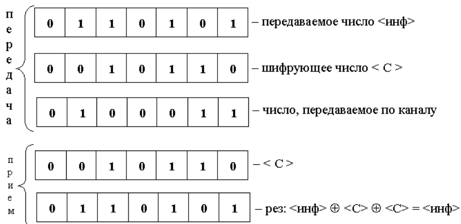
Рис. 5.3. Принцип шифрации в сетях GSM
